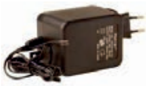
Trafo Giriş: 220VAC, 50 HZ Çıkış: 24 VAC 830mAh
